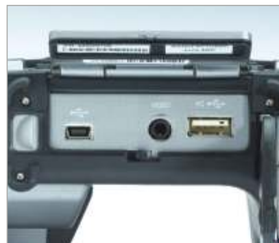
De la izquierda para la derecha: Mini USB para el transferencia de la imagen para una PC, Conexión del audio para grabación de la voz, Salida NTSC vídeo y USB-A tarjeta de memoria.
