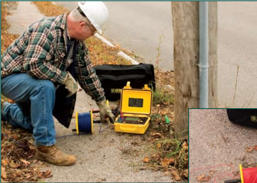
El Modelo 6470 comprueba rápidamente la resistencia de la barra de tierra mediante su sistema de Conectar – Presionar – Leer.
