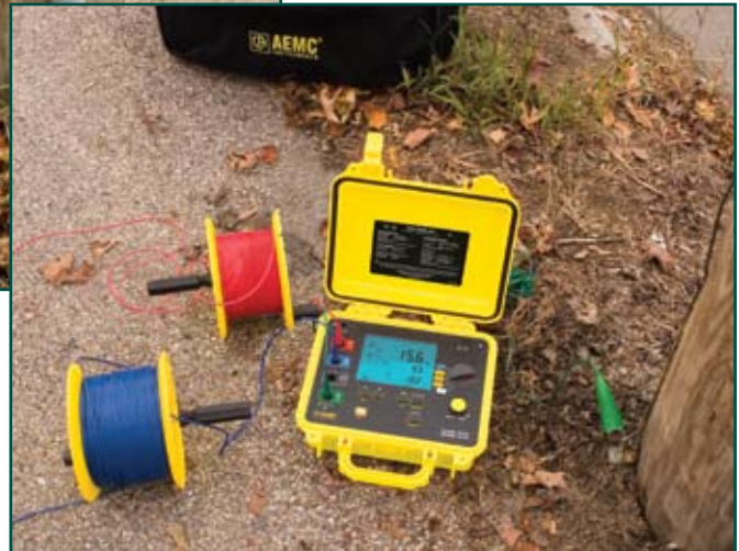
El Modelo 6470 comprueba rápidamente la resistencia de la barra de tierra mediante su sistema de Conectar – Presionar – Leer.
