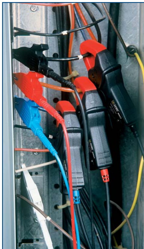
Mida el voltaje y la corriente de las tres fases simultáneamente.
