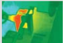
Motor (cojinete sobrecalentado)
